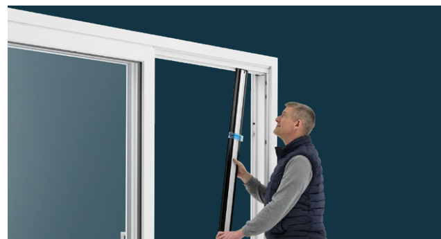
Schritt 1 InScreen Plisseekassette in die obere Führungsschiene einführen und anschließend in die Führungsnut der Schwellenkonstruktion einschwenken.
